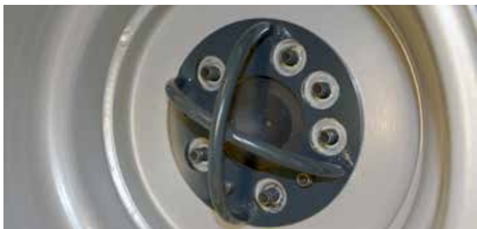
Surningsögla till hjulnav A423091
