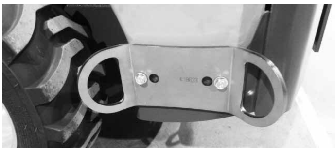
Surningsögla A418623 monterad bakom bakdäcken. För montering på sidan behövs två surrningsöglor.
